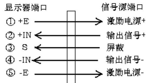
图 (二) 传感器与五芯航空针连线图
